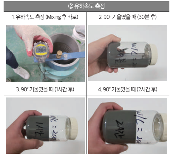
[그림 2] 유하속도 측정 장면
