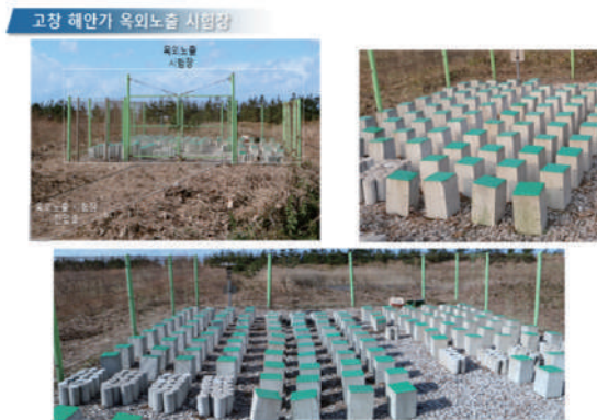
[그림 8] 고창 해안가 옥외노출시험장 전경
