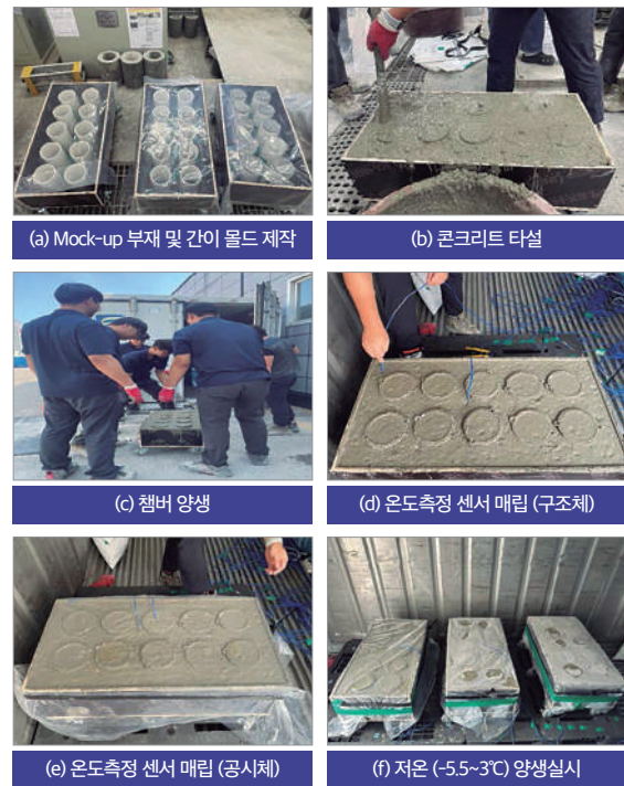
[사진 4.1] Mock-up 전경
