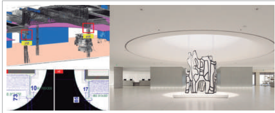
레이저 스캐닝, 모델링으로 간섭검토 및 천장고 확보 및 서비스 계획
