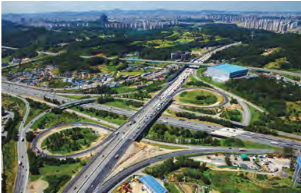
경부고속도로 확장 (수원 - 청원) 완공일 : 1993.07 L=9.48km (6차선: 6.48km, 8차선: 3.00km), 교량 (L=0.53km/11개소)
